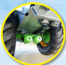
Eje de 150 mm y frenos de 420 x 180 mm sobredimensionados para la montaña
